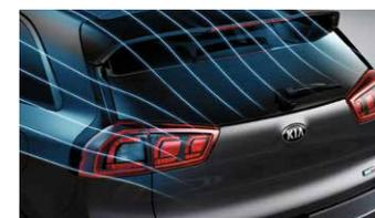
**Dachheckspoiler** Der Spoiler über der Heckscheibe trägt sowohl zur guten Aerodynamik als auch zur Fahrstabilität bei hohen Geschwindigkeiten bei.
