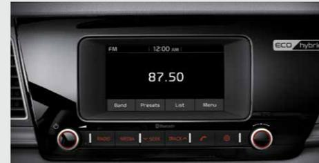
**Kia Radio mit 5-Zoll-TFT-LCD-Display\*** Das Audiosystem mit 5-Zoll-Touchscreen, RDS-Funktion und Audiostreaming via Bluetooth® ist serienmäßig mit sechs Lautsprechern kombiniert.
