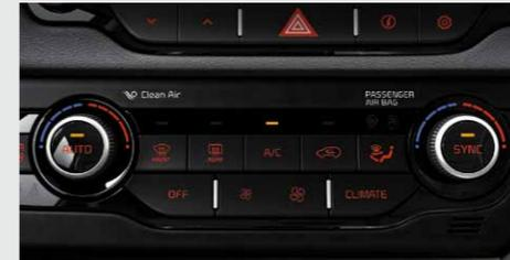
**Zwei-Zonen-Klimaautomatik** Mit diesem System, das die eingestellte Temperatur automatisch konstant hält, lassen sich die Fahrer- und die Beifahrerseite unterschiedlich temperieren.
