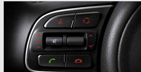
**Multifunktionslenkrad** Das Radio bedienen, die Spracherkennung aktivieren, Telefonanrufe annehmen, Tempolimits einstellen, die Bordcomputerdaten abrufen – alles, ohne die Hand vom Lenkrad zu nehmen.
