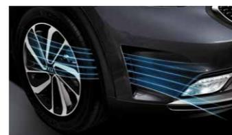
**Seitliche Lufteinlässe** Die seitlichen Lufteinlässe an der Fahrzeugfront reduzieren die Strömungsturbulenzen im Bereich der Vorderräder.
