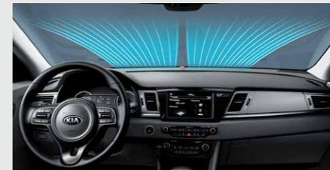
**Antibeschlagsystem** Wenn die Sensoren des Systems registrieren, dass die Frontscheibe beschlägt, wird automatisch das Gebläse gestartet, um wieder freie Sicht zu schaffen.
