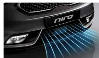
**Aktive Luftklappen** Die aktiven Luftklappen im unteren Kühlergrill schließen sich bei höheren Geschwindigkeiten und verringern so den Luftwiderstand.
