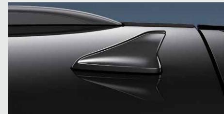
**Dachantenne im Sharkfin-Design\*** Die elegant gestaltete, aerodynamische Antenne gewährleistet einen guten Empfang von Radiosendern und Navigationsdaten.
