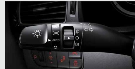
**Dämmerungssensor** Ist die Auto-Funktion aktiviert, schaltet der Sensor bei Dunkelheit und in Tunneln automatisch die Scheinwerfer und Rückleuchten ein.
