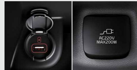
**USB-Ladegerät / 220V-Steckdose** Laden Sie Ihre USB-Geräte über die USB-Steckdose auf oder schließen Sie beispielsweise Ihren Laptop an die 220-V-H Haushaltssteckdose in der Rückseite der Mittelkonsole an.
