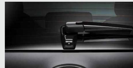
**Rückfahrkamera\*** Die Kamera ist elegant in die Halterung des Heckscheibenwischers integriert, wo sie zugleich besser vor Verschmutzung geschützt ist.
